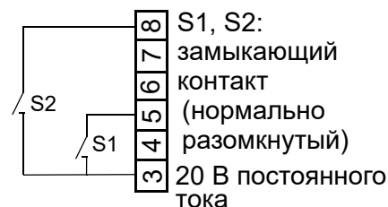
Клеммная колодка на ST08
