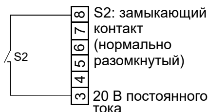
Клеммная колодка на ST08
